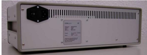
Photo 2-1: Rückseite des CONtesters mit Hauptschalter und Sicherung
