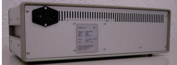
foto 2-1: Achterzijde van de CONtester met de hoofdschakelaar en de veiligheidszekering
